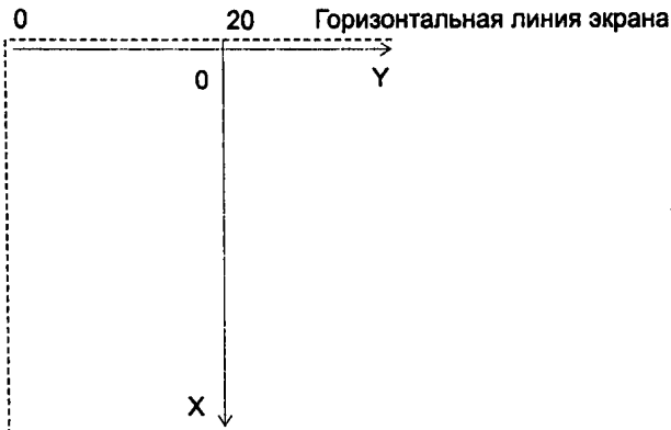
Рис. 2.24. Взаимное расположение экрана и осей координат
